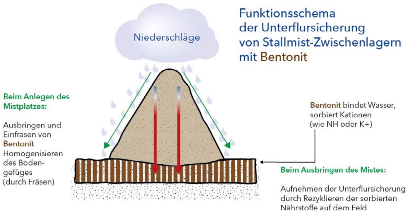
Abb. 1: Funktionsschema der Unterflursicherung von Stallmist Zwischenlagern mit Bentonit; (Dewes & Falter, Mist lagert sicher auf Bentonit, 1998)
