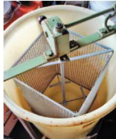
Ein guter Kauf – Schleuderkorb und Welle sind aus Edelstahl, die Schleuderwand aus Kunststoff und daher „rostfrei“.
