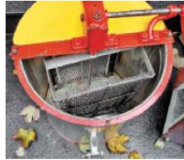
Auf den ersten Blick sieht diese Schleuder noch gut aus. Leider ist der Schleuderkorb schon leicht verrostet und muss ersetzt werden.
