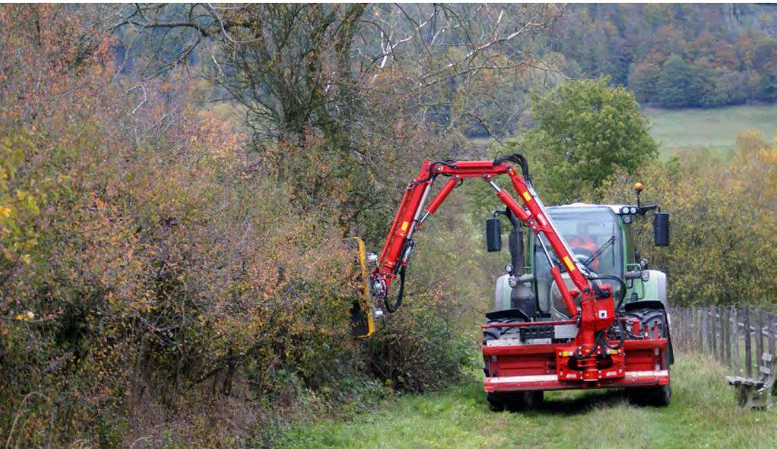
Heckenschnitt am Ausleger – nach dem seitlichen Schnitt kann dank Ausleger anschließend auch eine horizontale Einkürzung erfolgen.
