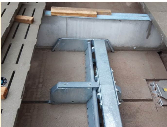
Abb. 43: Unterflurschieber mit Kot-Harn-Trennung zur Senkung der Emissionen
