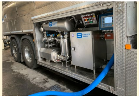
Abb. 54: Milchsammelwagen während einer laufenden Prüfung. Die Rohmilchproben müssen bei hintereinander erfassten Mengen und unterschiedlichen Fettgehalten gesetzlich vorgeschriebene Kriterien vor allem hinsichtlich Verschleppung und Repräsentativität erfüllen.
