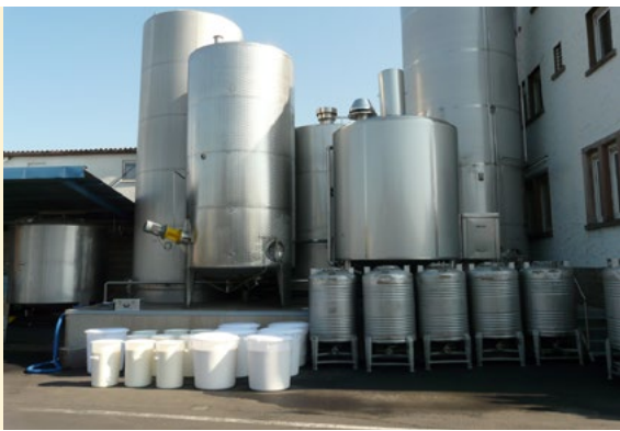
Abb. 53: Milchbehälter gefüllt mit Rohmilch unterschiedlichen Fettgehaltes zur Funktionsprüfung der Probenahmeanlagen von Milchsammelwagen
