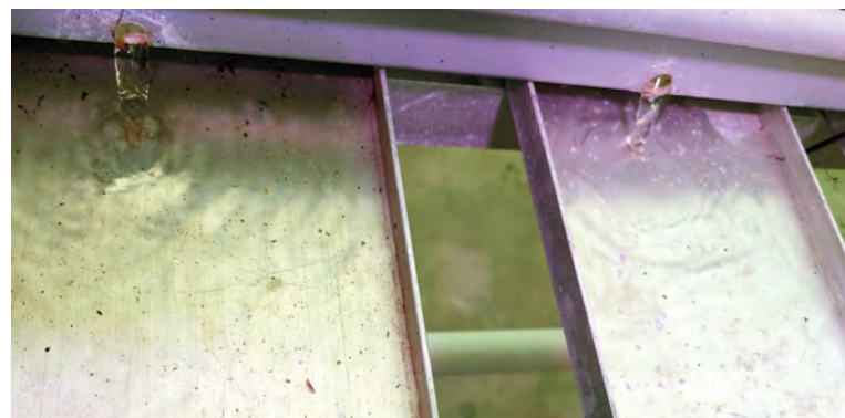
Abb. 1: Durch das Einschalten der Umwälzpumpe wird Wasser durch die Fließbrinnen geleitet
