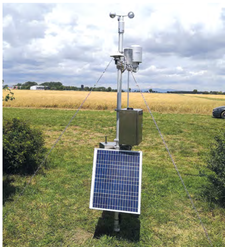
Abb. 1: Wetterstationen sammeln lokale Wetterdaten, die etwa zur Entwicklung intelligenter Bewässerungssysteme genutzt werden können
