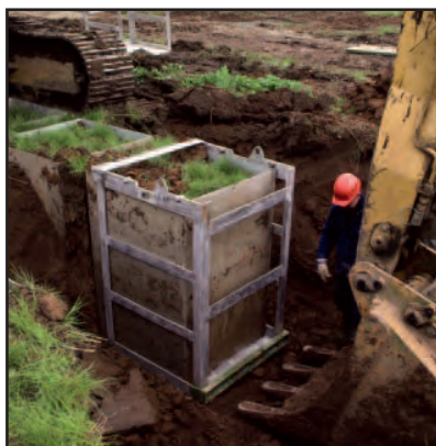
Abbildung 4: Entnahme der gefüllten Lysimeterbehälter
