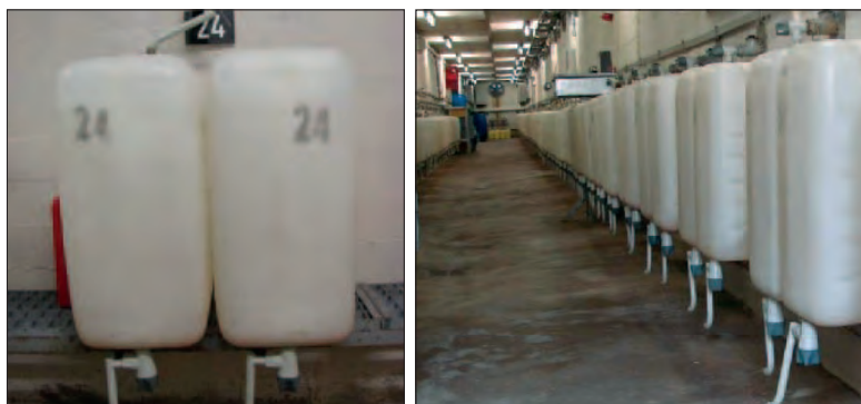
Abbildung 3: Begehbare unterirdische Sickerwasserauffanganlage der Lysimeterstation in Falkenberg (Altmark)
