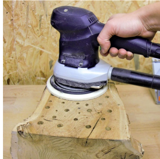
Abb. 7: Schleifen des Nistholzes nach dem Bohren.
