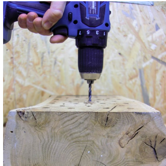
Abb. 3: Es sollte stets quer zur Faser gebohrt werden.
