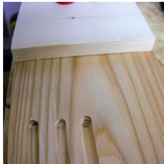
Abb. 13: Ein Stück Holz dient als Anschlag (Stopper) für die Oberfräse, so werden die Nuten gleich lang.
