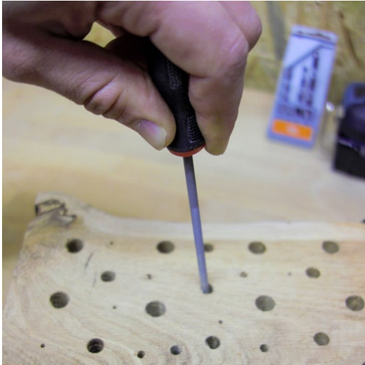
Abb. 6: Entgraten der Bohrlöcher.
