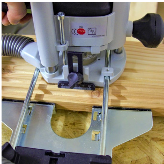
Abb. 12: Fräsen der Nuten mittels Oberfräse und Parallelanschlag
