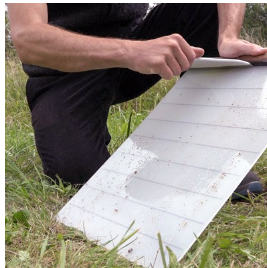
Abb.: 6. Mit einem Abzieher wird der Bodenschieber gereinigt
