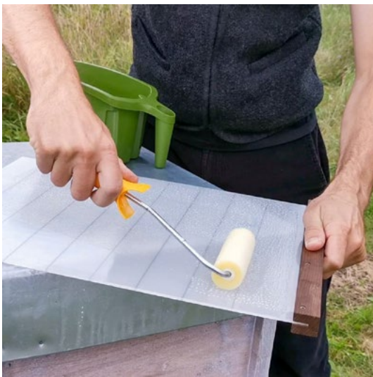
Abb.: 5. Mit einer Farbrolle wird das Öl aufgetragen
