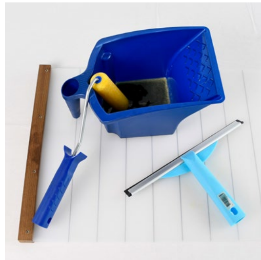
Abb.: 4. Benötigte Materialien: Bodenschieber, Gefäß mit Öl, Farbrolle, Abzieher
