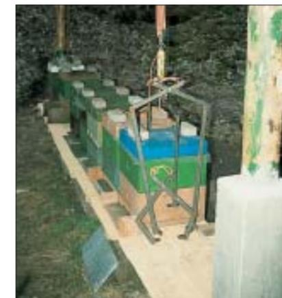
Aus 15 × 30 mm-Vierkantrohr sind die Scheren in drei verschiedenen Größen zum Abheben von ein bis vier Zargen gefertigt.
