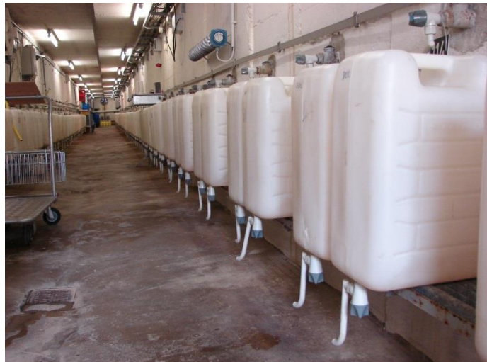
Abbildung 1: Schematischer Aufbau eines Gravitationslysimeter an der Lysimeterstation in Falkenberg nach Godlinski, 2005 (links) und Sickerwasserauffanganlage (rechts)
